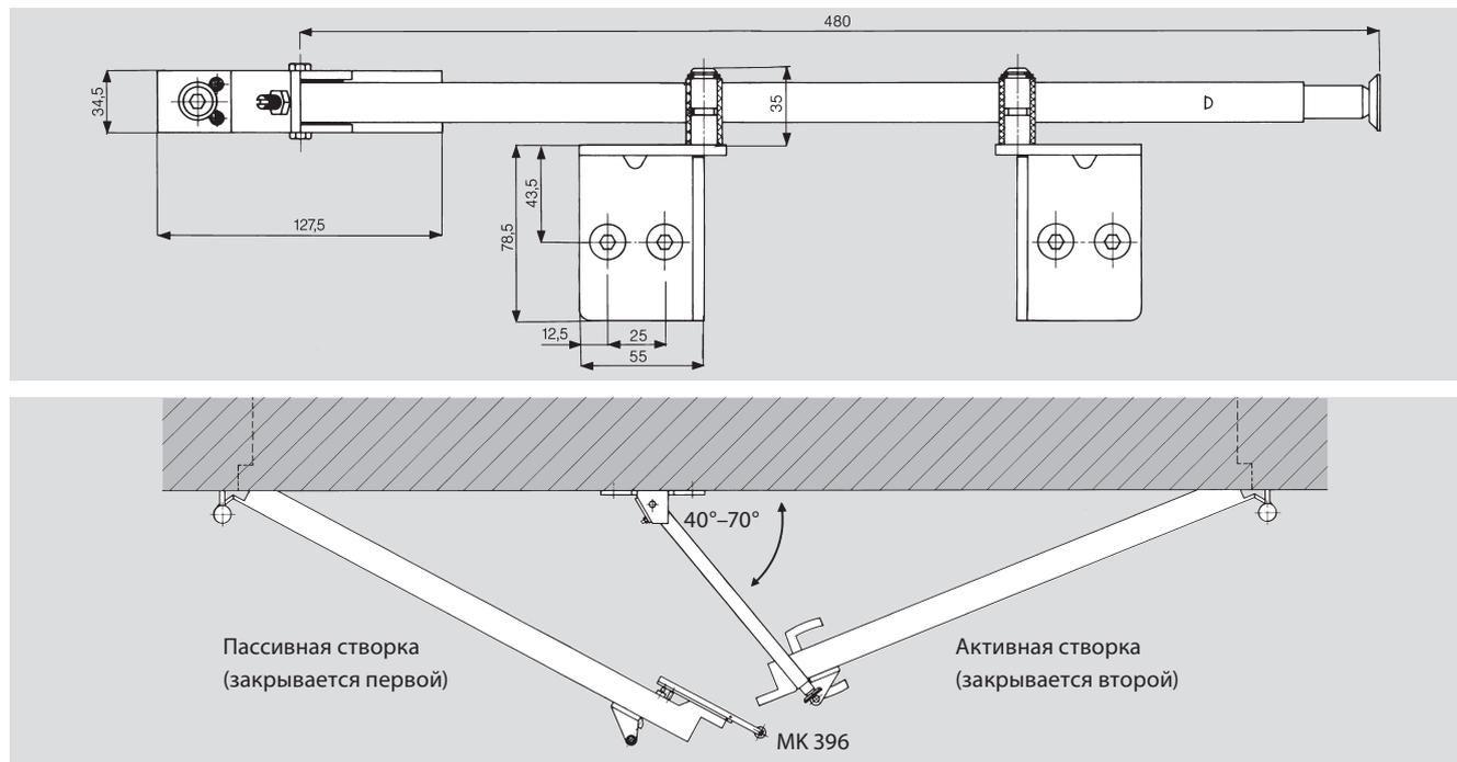
SR 390 – прошедший все испытания механический координатор последовательности закрывания створок для двухстворчатых дверей с притвором.
