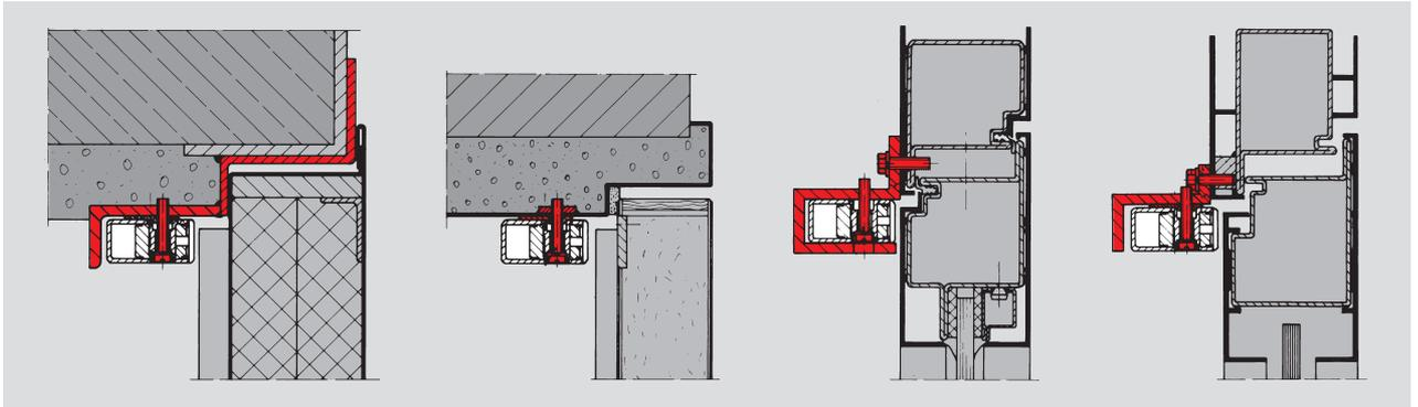
Определение правильного размера координатора SR 392 для дверей с различной шириной створок
