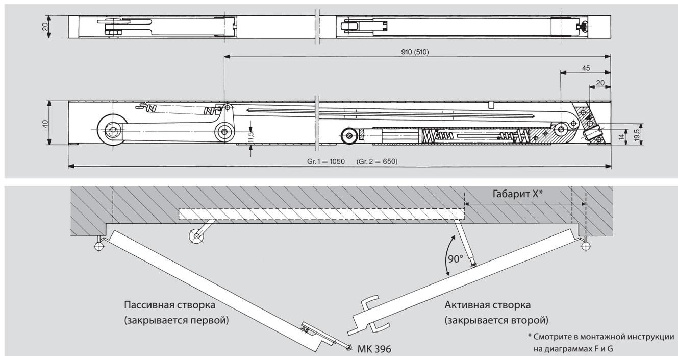
SR 392 – координатор последовательности закрывания створок для двухстворчатых дверей с притвором.
